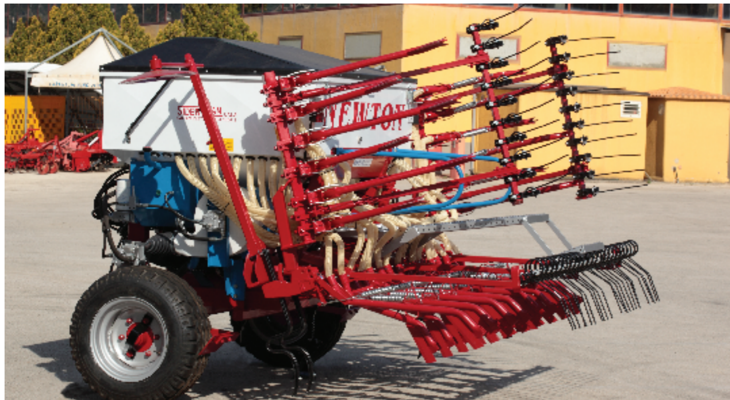
Seminatrice in fase di trasferimento - Ruote 13.0/55 - 16 di serie Il battistrada di 33 cm di larghezza consente una migliore galleggiabilità della seminatrice nei terreni particolarmente soffici
