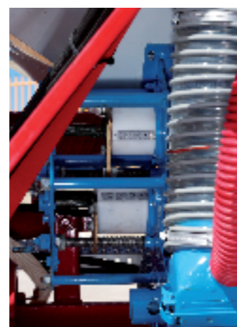
Dosatore con doppio rullo per seme e concime o due tipologie di seme
